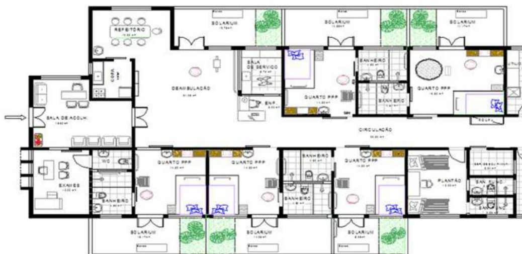
Figura 7 – Layout do projeto de referência de um Centro de Parto Normal – CPN. Fonte: Equipe de obras da Rede Cegonha.
