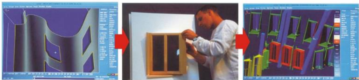
Figura 09: Estudo de um elemento de fachada.
