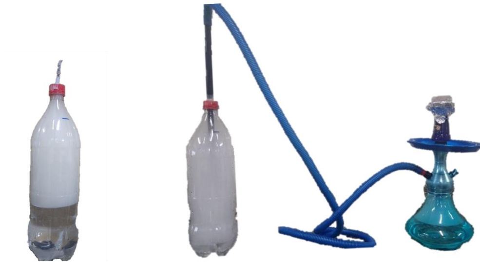
Figura 8- Garrafa pet recolhendo a fumaça do cigarro (a direita) e do narguilé (a esquerda) para posteriormente esta passar pelo sistema de filtragem.
