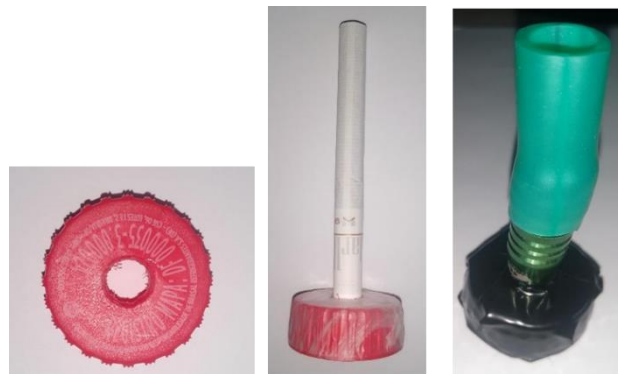
Figura 9- Buraco na tampa para o encaixe do cigarro (direita), cigarro encaixado na tampa (centro), fixação da piteira da mangueira de narguilé à tampa (esquerda)
