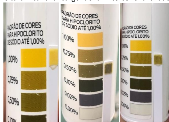
Fotografias 1, 2 e 3 - Escala de cores utilizada com exemplos de leituras para a classificação das amostras de NaClO quanto ao teor de cloro ativo.
