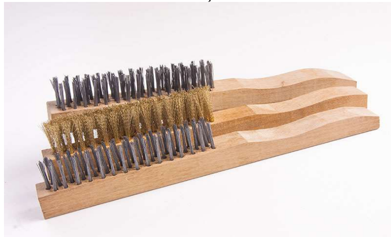
Figura 13 - Tipo de escova de aço utilizada na limpeza de oxidação
