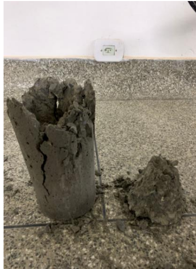
Figura 20 – Corpo de prova rompido - 01/10/2021.
