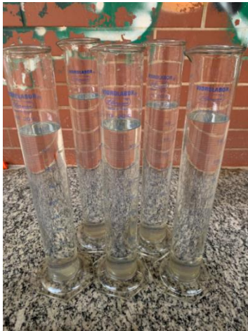
Figura 15 – Água da chuva tratada para a fabricação do concreto.
