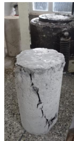
Figura 14 – Corpo de prova rompido - 21/09/2021.
