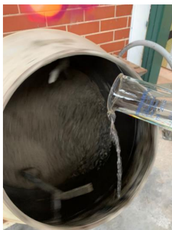
Figura 17 – Adição da água pluvial tratada na fabricação do concreto.
