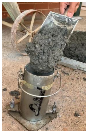
Figura 8 - Concretagem do corpo de prova
