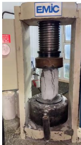
Figura 13 – Corpo de prova rompido - 14/09/2021.
