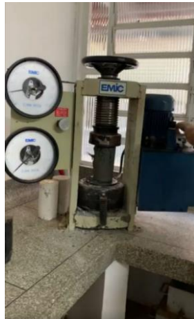
Figura 11 - Rompimento do corpo de prova - 27/08/2021.
