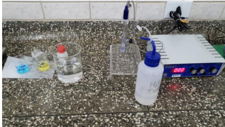
Figura 3 – Medidor de pH e soluções para calibrar o equipamento.
