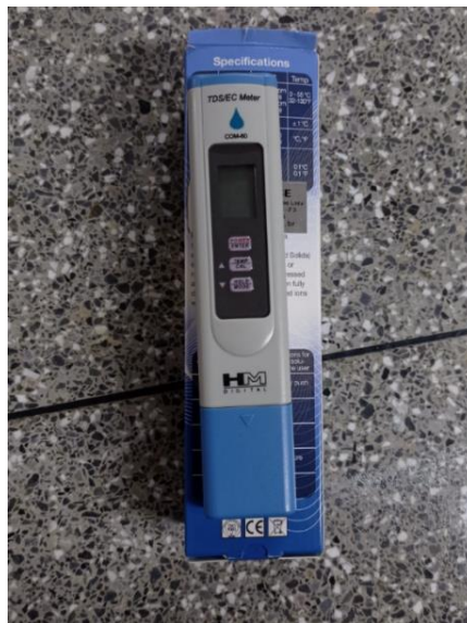
Figura 5 – Medidor de Sólidos e Condutividade Elétrica.
