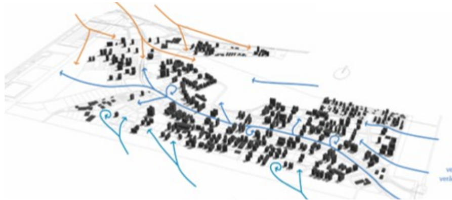
Figura 21: esquema de ventilação de Águas Claras.
