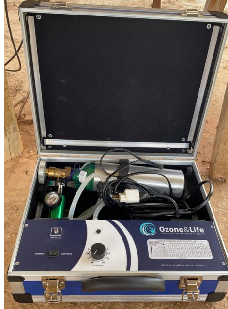
Figura 07: Equipamento gerador de ozônio
