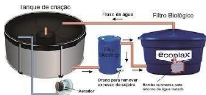
Figura 2 - Sistema simples de recirculação de água para cultivo de peixes em caixa d'água
