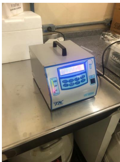
Figura 6- Máquina de congelamento programável
