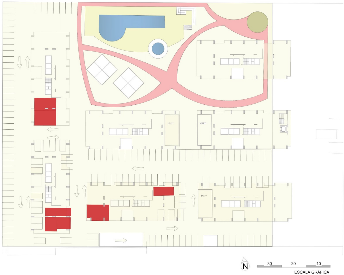
Figura 90 - Planta de demolição
