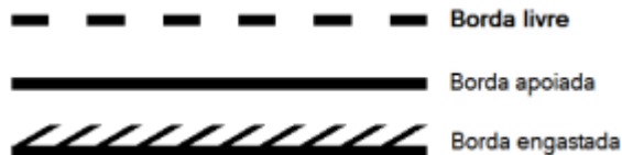
Figura 6 – Representação de tipos de apoio
