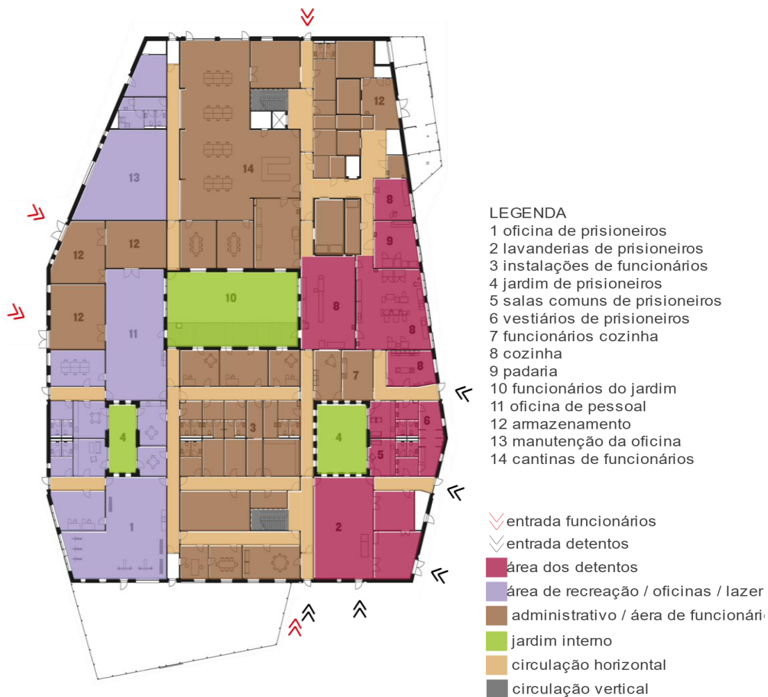
Figura 12-Planta baixa – Prédio de Trabalho
