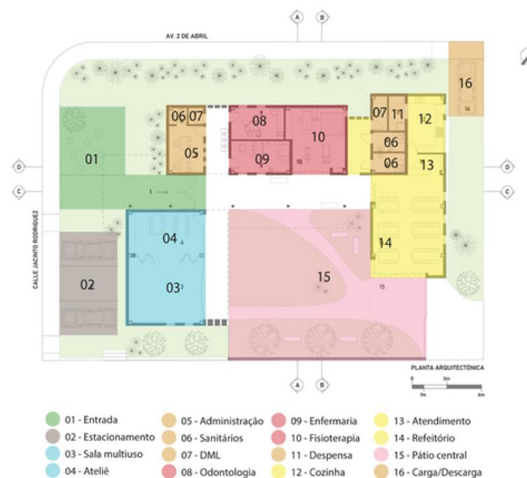
Figura 16: Planta de setorização: Centro dia para idosos - Macas, Equador
